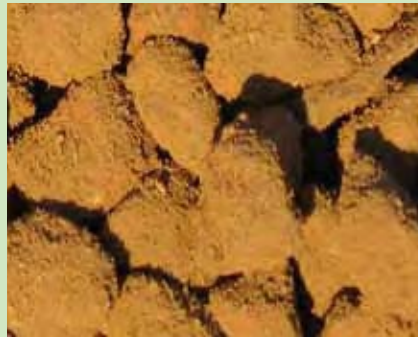
Figure 11. Le sol Davis, un sol non porteur (non structural) au taux d'infiltration élevé avec un bon potentiel de stockage des eaux.
