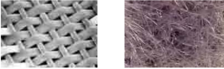
Figure 9. Vue agrandie de géotextiles tissés et non tissés. Photos tirées de « IGS Geosynthetics in Drainage and Filtration by J.P. Gourc and E.M. Palmeira ».
