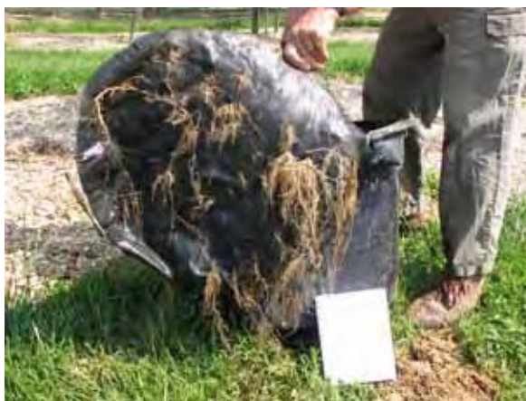
Figure 19. Racines d'un frêne ayant pénétré dans le géotextile après que le sous-sol compacté ait été enlevé. Les racines ont multiplié le taux d'infiltration par 27.
